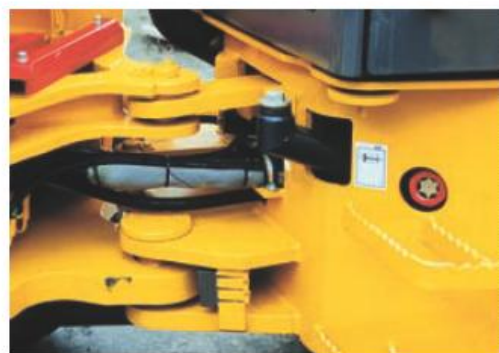
ELGES球面すべり軸受を使用した連結節／スィベル・ジョイント
