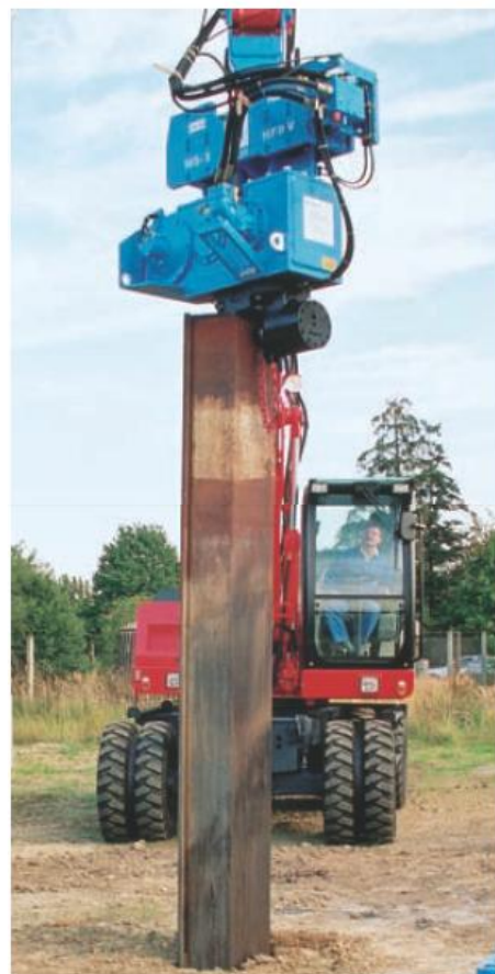
求められる動荷重：円筒ころ軸受LSLシリーズは高加速度に耐えることができます。振動杭打機置の起振機（写真：Thyssenkrupp）
