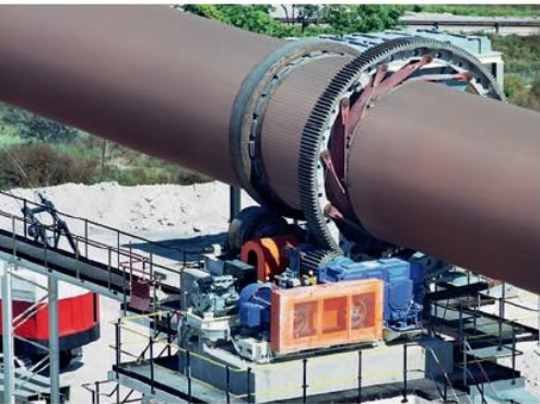
フレンダー社チューブ・ミル・ドライブ：減速機にINA/FAG転がり軸受が使用されています。（写真：Flender）
